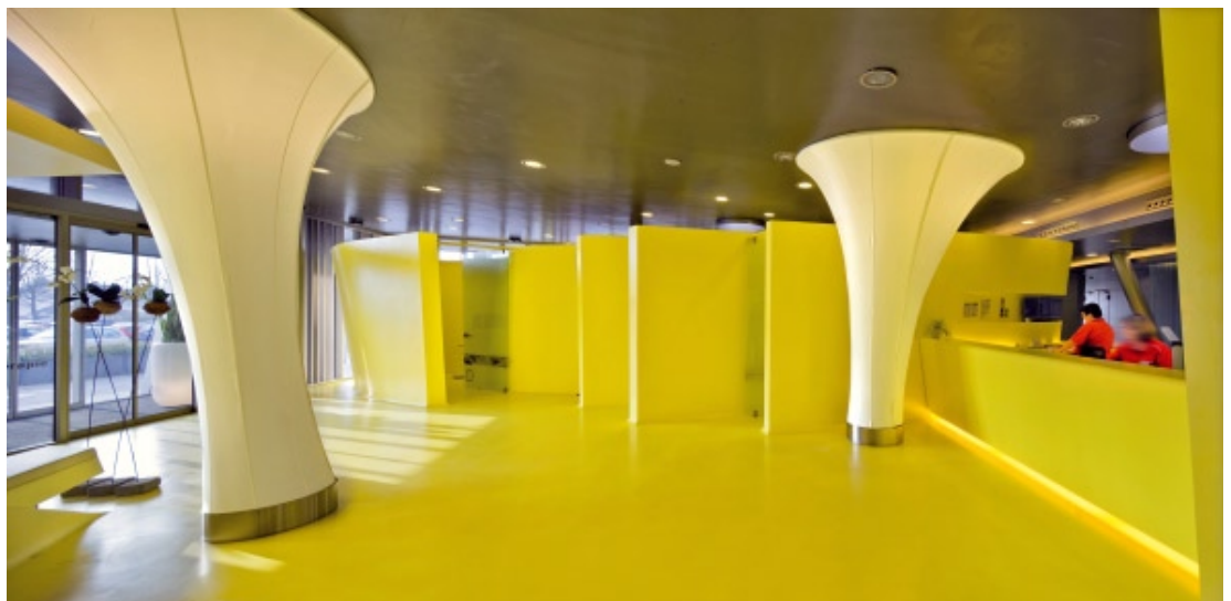
Wie aus einem Guss: Boden und Wand sind mit Caparol Disbon 447 in Gelb beschichtet. Im Empfangsbereich wachsen mit weißem Textil bespannte Leuchten wie Blütenkelche aus dem Boden.
